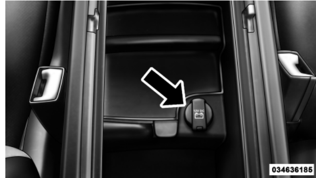
Center Console 12 Volt Power Outlet
