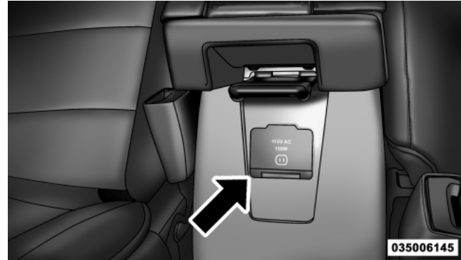
115 Volt Power Outlet
