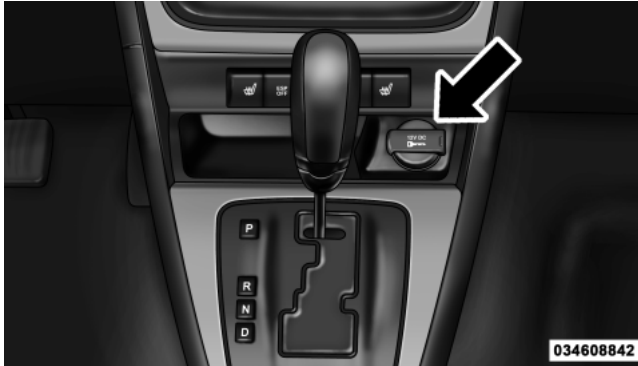
12 Volt Power Outlet
